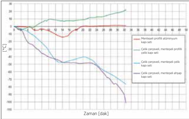
Şekil 6. Yangın merkezinin iç kısmına doğru açılan kapı kanadı ve yangın merkezinin dışına doğru açılan kapı kanadı için kapı çerçevesi yüzeyleri üzerindeki ortalama sıcaklık artışları arasındaki fark
