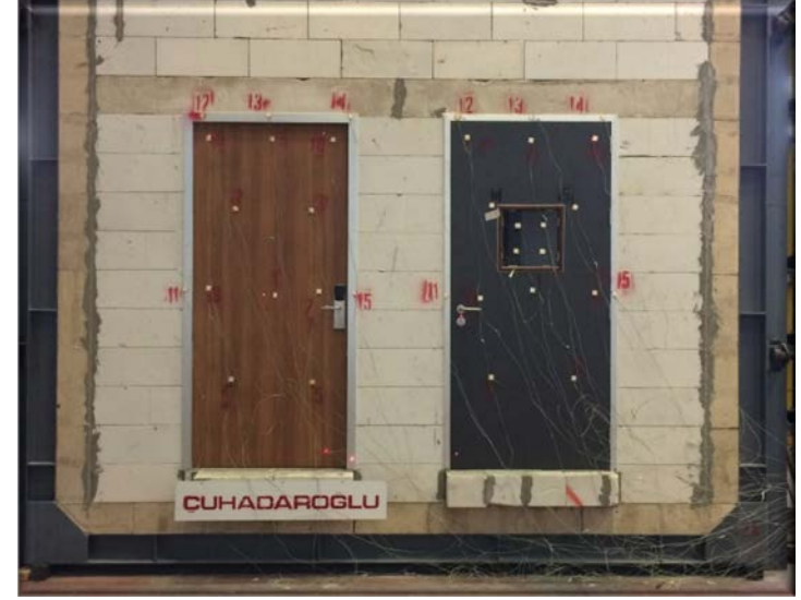
FP 48-30 . Yangına Dayanımlı Ahşap Panel Alüminyum Kasa Kapı (test)
