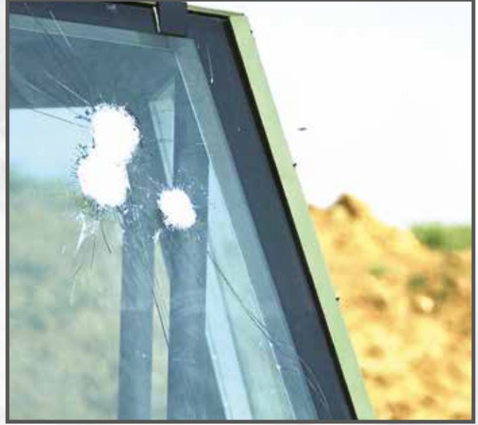
FB7 Kurşun geçirmezlik testi FB7 Testing for bullet resistance
