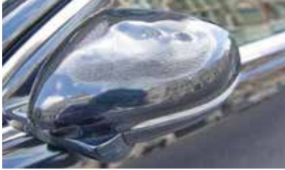
Resim 4. Yansıyan ışığın komşu binadaki dükkanın giriş kapısındaki paspasta oluşturduğu yanık ve sokakta park halinde bulunan bir Jaguar marka aracın boyasındaki oluşturduğu tahribat.
