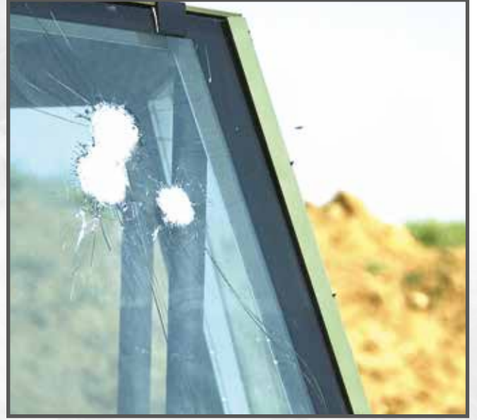
FB7 Kurşun geçirmezlik testi FB7 Testing for bullet resistance
