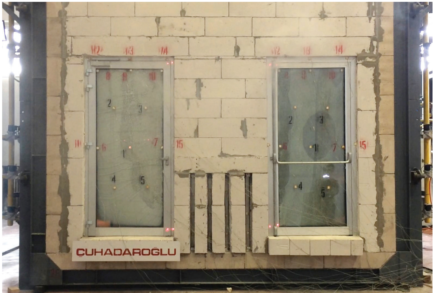
DS 92 YD Yangına Dayanımlı Camlı Kapı EI 90 Özelliği
