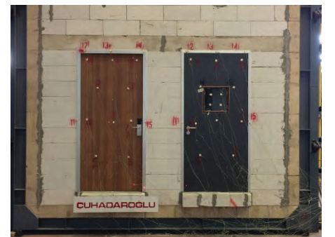
FP 48-30 . Yangına dayanımlı ahşap panel alüminyum kasa kapı (test)
